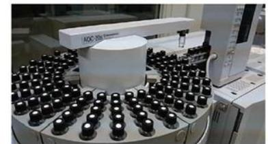
ゲノミック評価用データの取得には精度の高い、ガスクロマトグラフィー（GC）を用いています。
