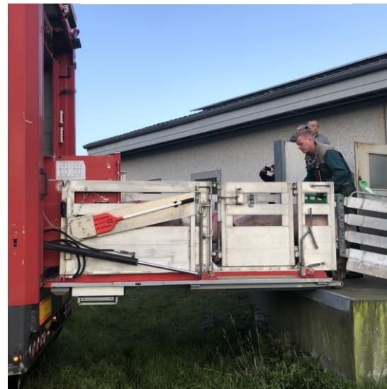
転落防止の横板
